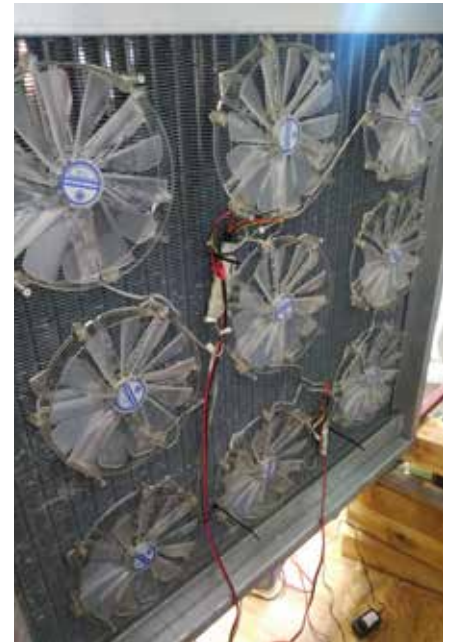
Obr. 2 Ventilátory inštalované na výmenník
